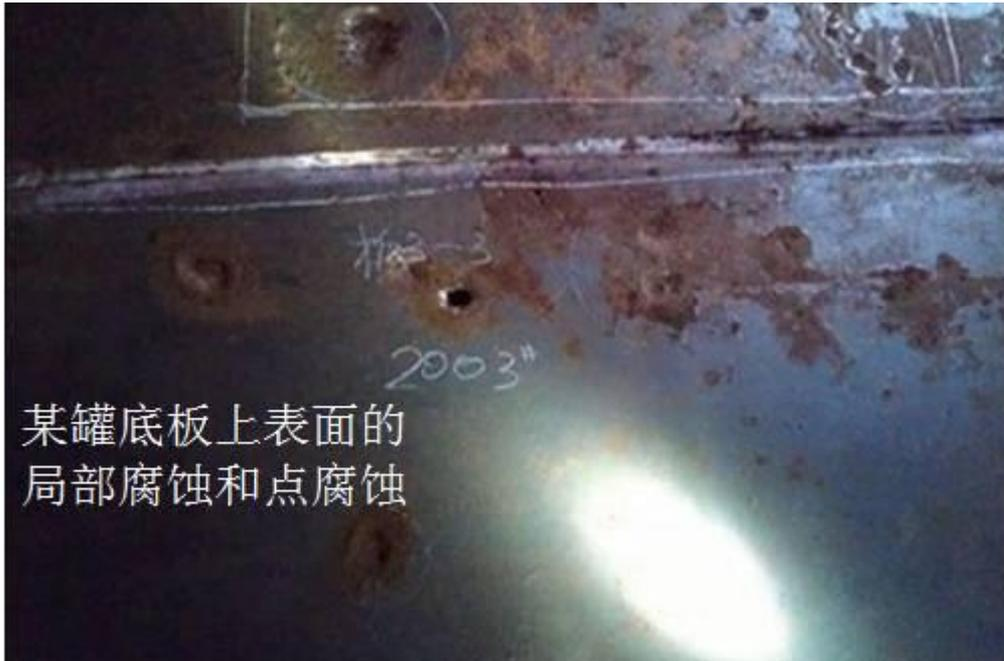
**储罐底板的介质侧**一般腐蚀的会比壁板更加严重，有时甚至会腐蚀穿孔而出现泄漏现象。这些腐蚀主要源于灌内的沉积水，沉积水中的硫化物、氯化物、氧等物质会与金属发生反应，造成的电化学腐蚀。
